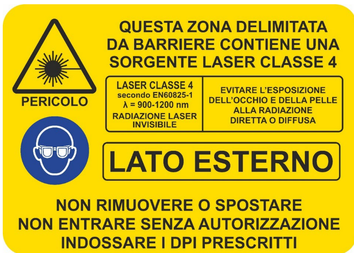
Figura 6.1 Avviso posto sul lato esterno della barriera
